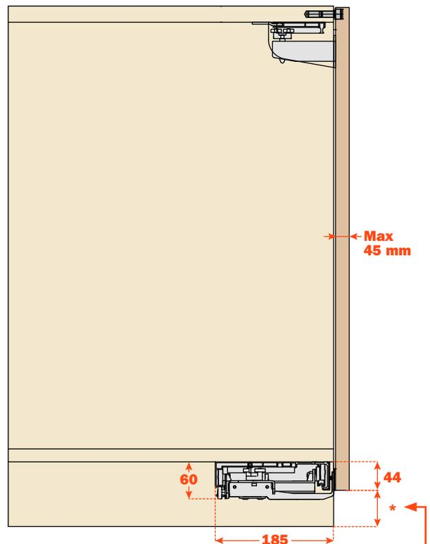
Minimaler Platzbedarf zum Befestigen und Einstellen 35 mm.
