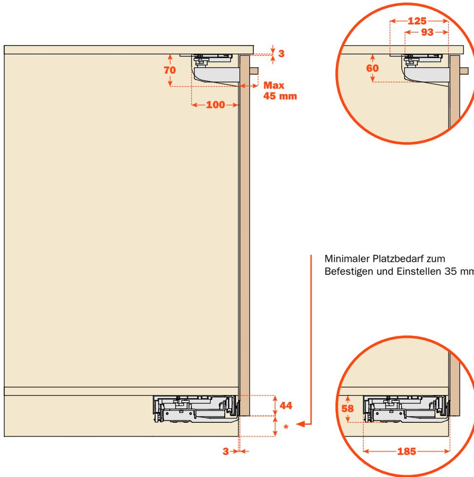
Minimaler Platzbedarf zum Befestigen und Einstellen 35 mm.
