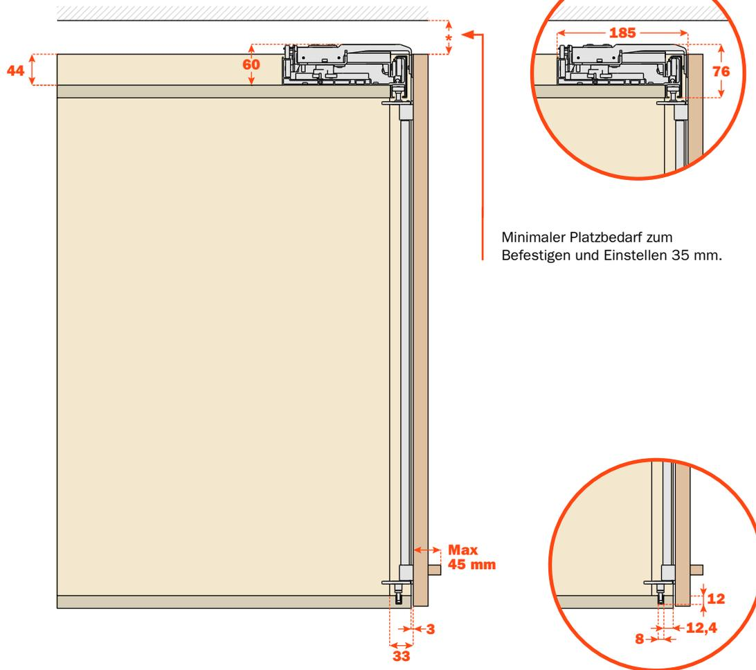
Minimaler Platzbedarf zum Befestigen und Einstellen 35 mm.
