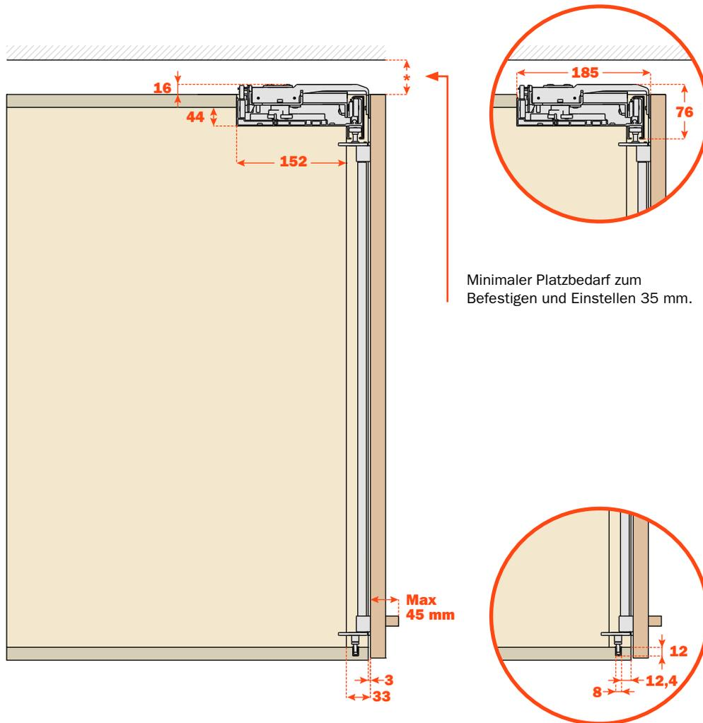
Minimaler Platzbedarf zum Befestigen und Einstellen 35 mm.
