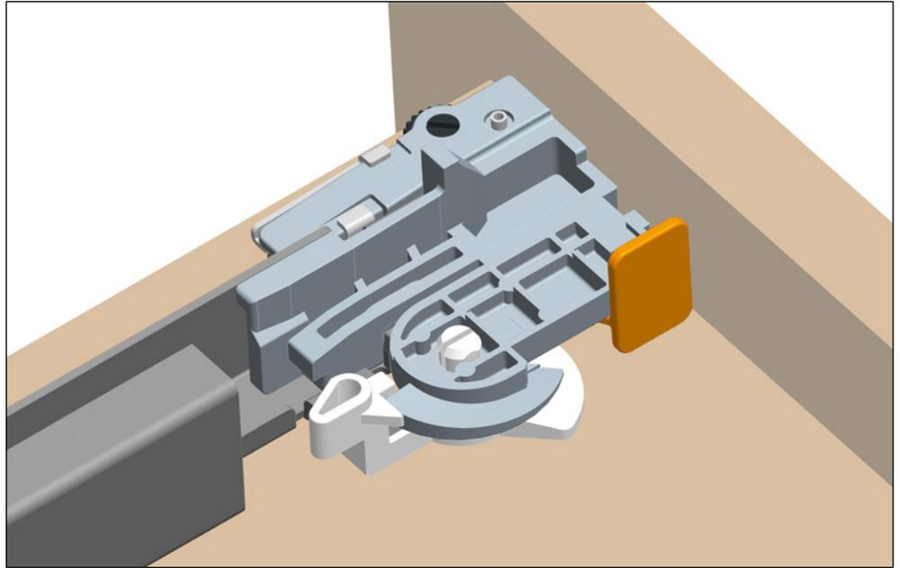
Bei Verdrehung des Hebel gegen die Frontblende der Schublade, wird eine Höhenverstellung von bis + 3 mm erreicht. Diese Verstellung kann werkzeuglos durchgeführt werden.
