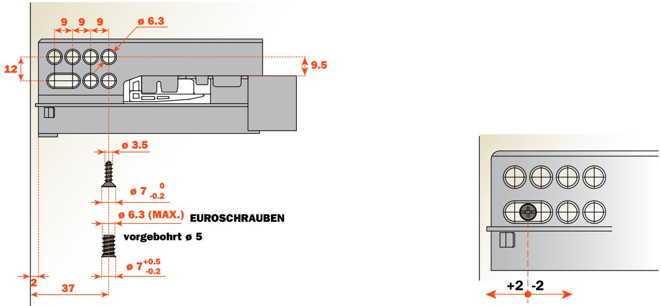
Die ovale Nut erlaubt die Höhenverstellung der Schublade. Dank dieser Nut ist die Ausrichtung der Frontblende von Kommoden mit innenliegenden Schubladen oder mit Futura Push möglich.
