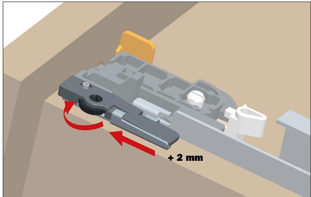
Das schwarze Rädchen in Richtung Rückseite der Schublade drehen, um den Abstand zwischen der Frontblende und der Seite zu vermindern. Diese Verstellung kann werkzeuglos durchgeführt werden.
