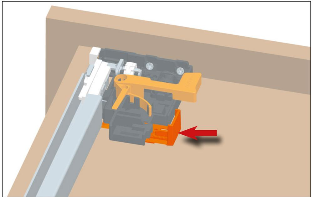
Den Hebel in Richtung Außenseite der Schublade drücken, um die Höhenverstellung zu erreichen.
