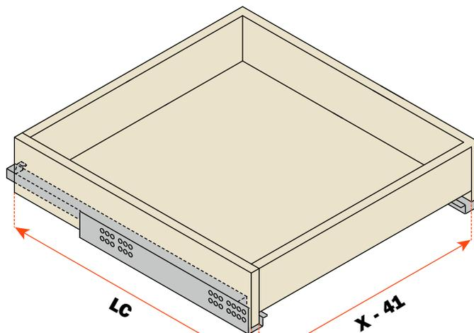
Die Länge der Schublade ist 10 mm weniger als die Länge der Führung
