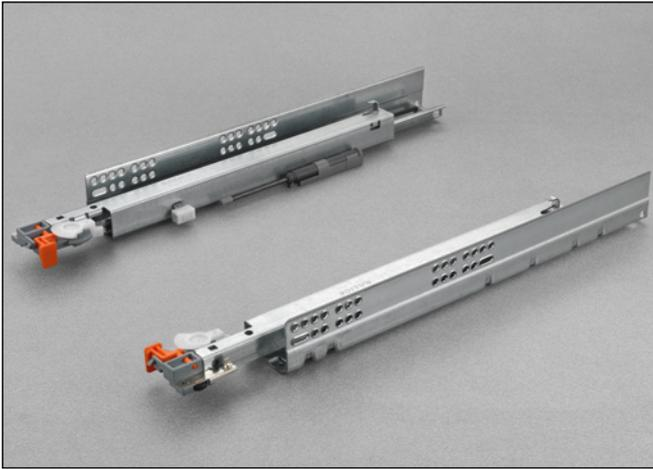
**Vollauszug, Befestigung der Schublade mit Stift-Clipversion. Integriertes Push System in der Führung, ermöglicht durch leichtes Drücken auf die Front das Öffnen der Schubladen bei grifflosen Möbelfronten. Dämpfungssystem Smove integriert in der Führung, zur sanften und geräuschlosen Schließung der Schublade.**
