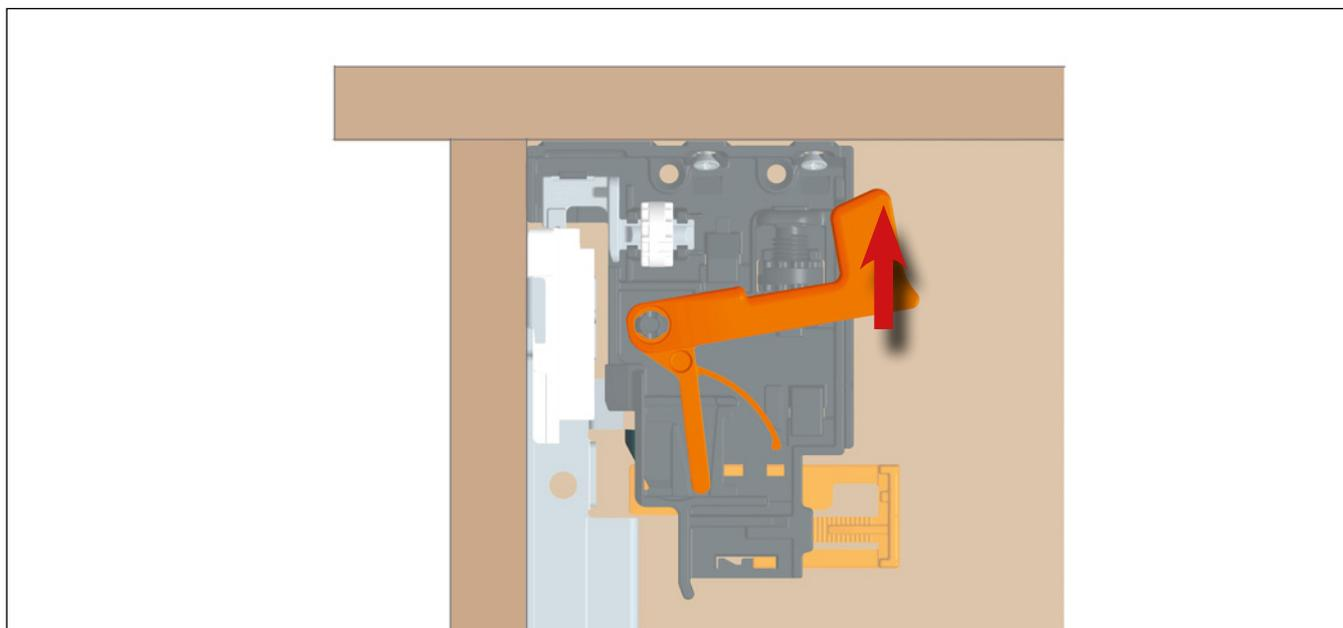
**Seitliche Demontage:** unter beide Seiten der Schublade greifen und die orangenen Hebel nach außen ziehen, wie auf der Zeichnung abgebildet und die Schublade nach vorne entnehmen.
