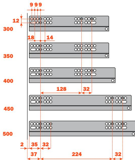
Für die Push-Funktion ist unbedingt der Wert  $A = 2,5$  mm erforderlich. Dieser Wert wird erreicht bei der Positionierung der Führung im Abstand von  $37$  mm von der Möbel-Innenkante.
