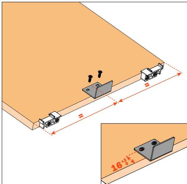
2) Befestigung des Magneten am Schrankboden.
