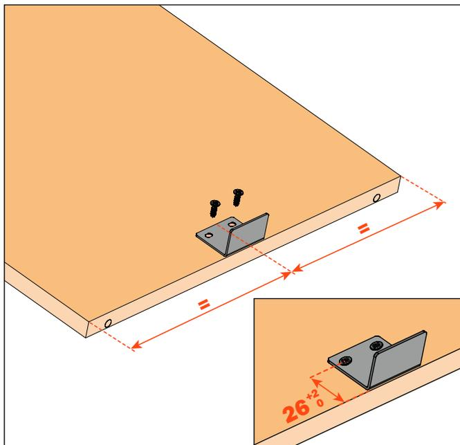
1 B) Befestigung des Eckwinkels am Ausziehboden bei Verwendung des hinteren Aufnahmeadapters für den hinteren Zapfen. In diesem Fall muß der Eckwinkel an dem Adapter für hinteren Zapfen ausgerichtet werden.
