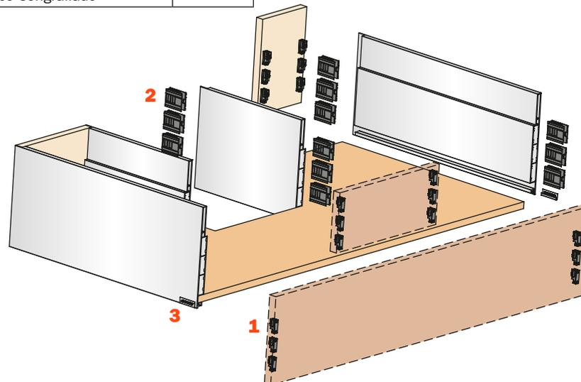
**Lineabox - 2 Lados - Desagüe sifón - Parte posterior rebajada - H 75 mm**
