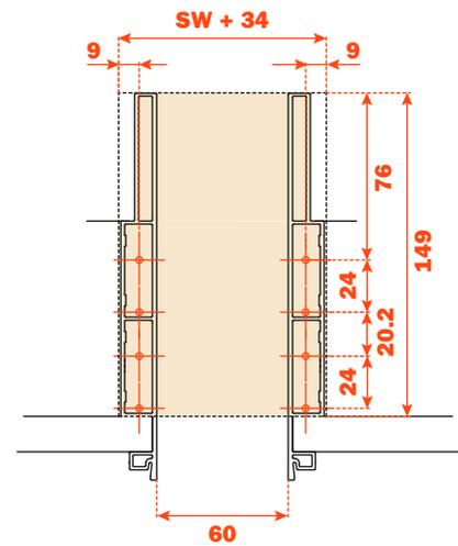
**Lineabox - 3 Lados - Desagüe sifón - H 75 mm**
