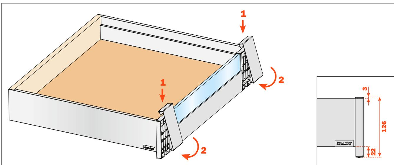
Para corregir cualquier error de corte del perfil, aflojar y apretar los tornillos indicados.
