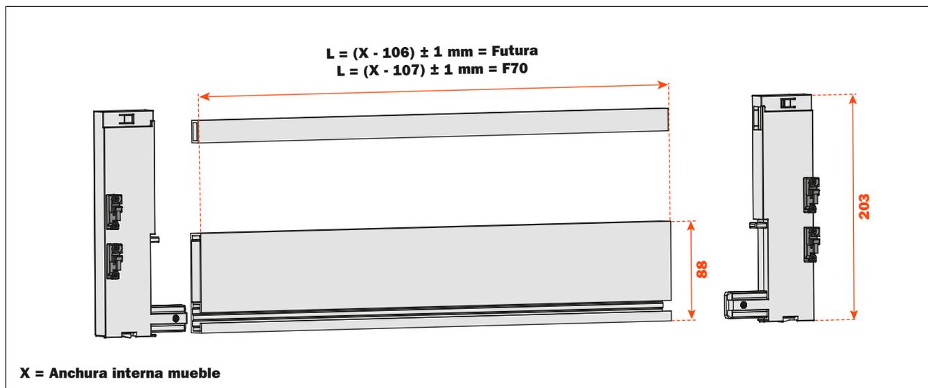
Insertar los terminales en el perfil frontal y en la barra y atornillar.
