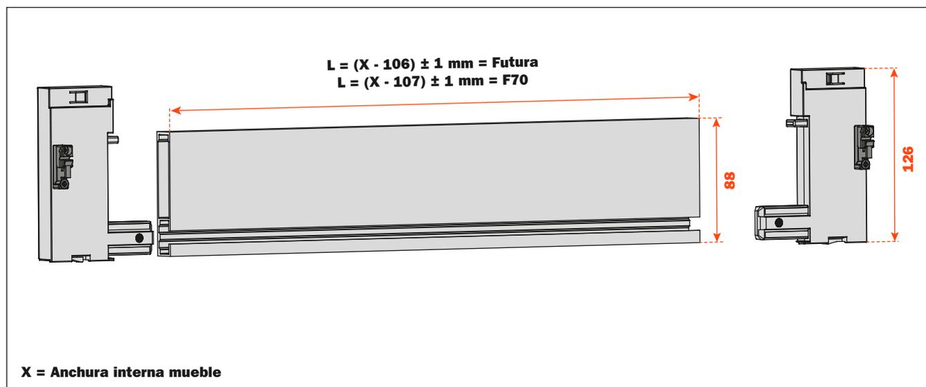
Insertar los terminales en el perfil frontal y atornillar.
