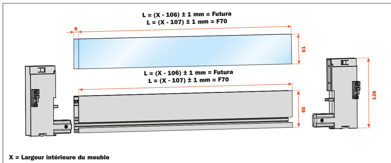
Insérer les attaches façades dans le profilé avant et visser.
