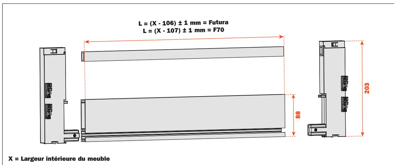
Insérer les attaches façades dans le profilé avant et dans la barre et visser.
