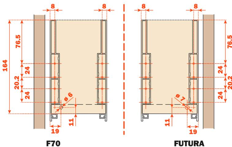
**Lineabox - 2-teilig - Bodenausschnitt - H 237 mm**
