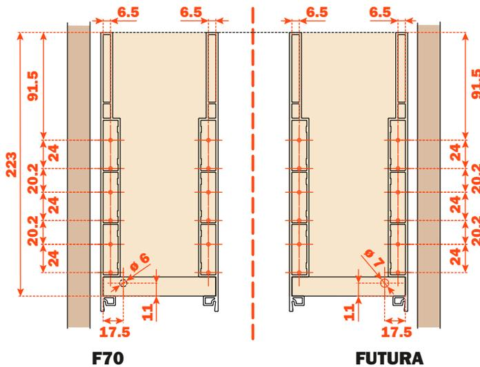
**Lineabox - 2-teilig - Waschbeckenschublade - Verdeckte Rückwand - H 75 mm**
