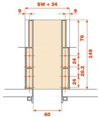
**Lineabox - 3-teilig - Bodenausschnitt - H 75 mm**
