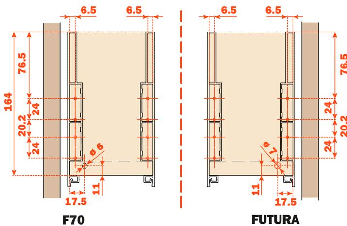
**Lineabox - 2-teilig - Waschbeckenschublade - Verdeckte Rückwand - H 237 mm**
