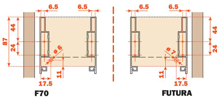
**Lineabox - 2-teilig - Waschbeckenschublade - Verdeckte Rückwand - H 178 mm**
