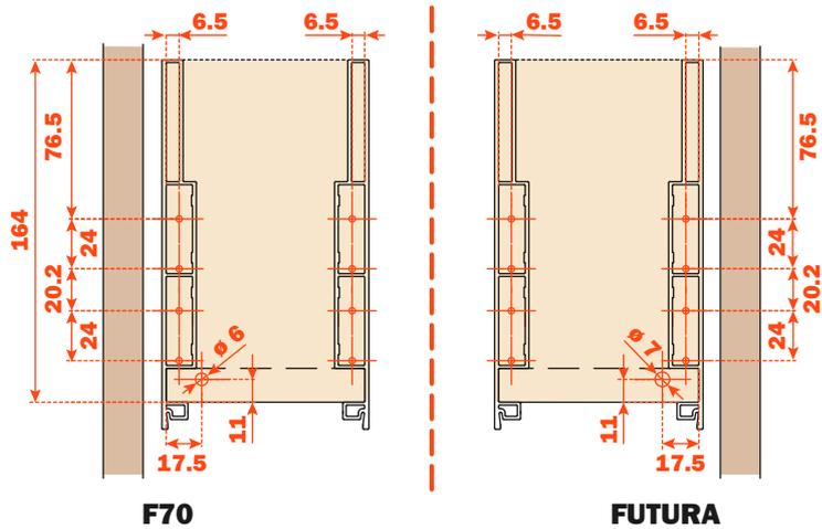
**Lineabox - 2-teilig - Bodenausschnitt - Verdeckte Rückwand - H 237 mm**
