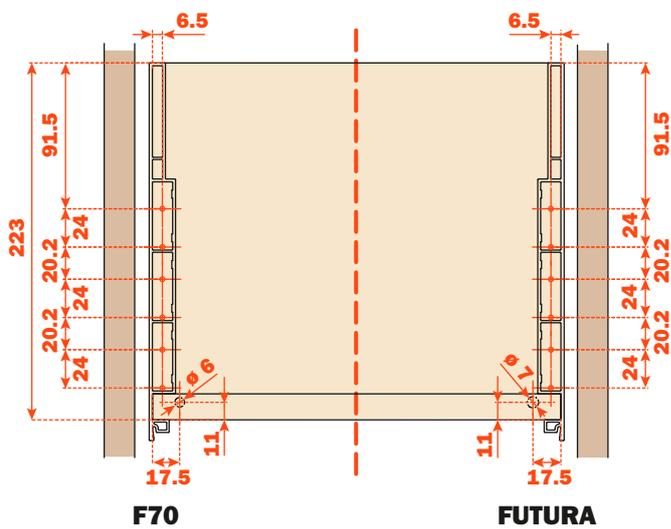
**Lineabox - 2-teilig - Verdeckte Rückwand - H 75 mm**
