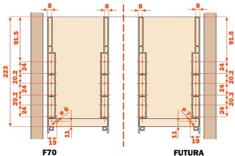
**Lineabox - 2-teilig - Bodenausschnitt - H 75 mm**
