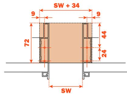
**Lineabox - 3-teilig - Bodenausschnitt - H 178 mm**
