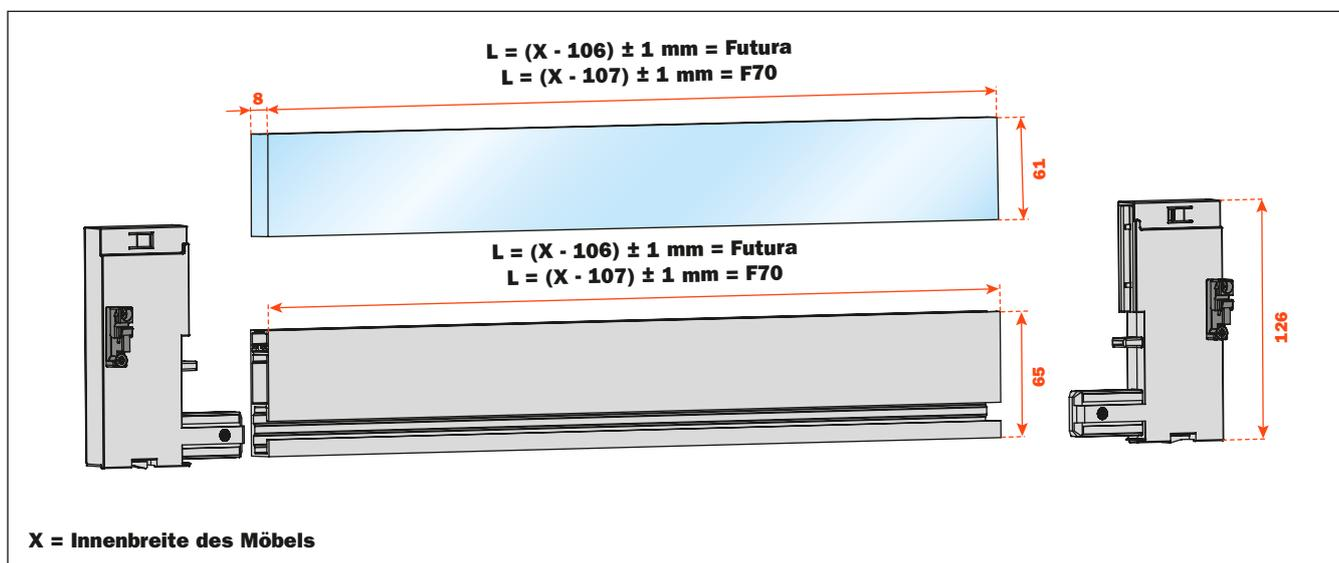
Die Fronthalter in das vordere Profil einsetzen und festschrauben.
