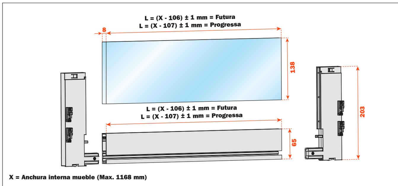
Insertar los terminales en el perfil frontal y en la barra y atornillar.
