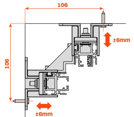
O ajuste frontal de um montante gera o deslocamento lateral do outro
