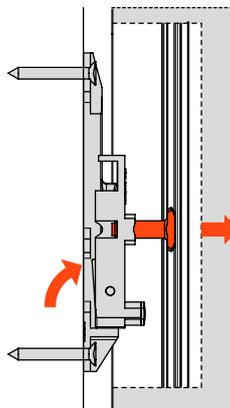
Desparafuse completamente o parafuso de fixação
