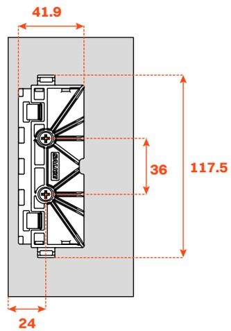
Espessuras dos painéis: de 12 mm a 19 mm
