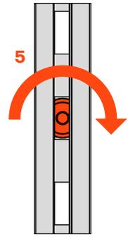
Bloquer l'élément de fixation dans le profil en respectant les cotes indiquées par le configurateur
