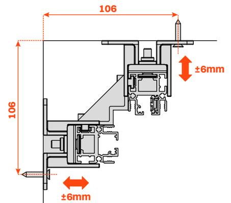
Le réglage frontal d'un profilé vertical entraîne le déplacement latéral de l'autre profilé
