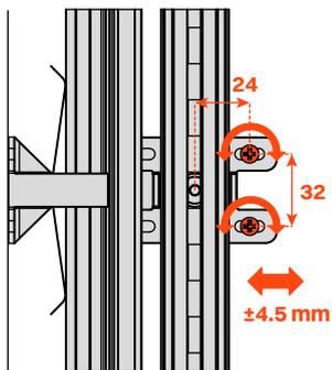
Réglage avant avec profilé vertical d'angle
