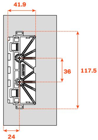
Épaisseurs des panneaux : de 12 mm à 19 mm
