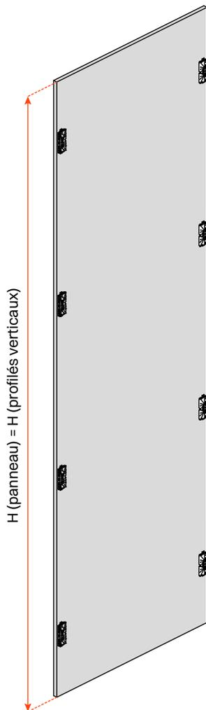
Clips auto-centrés pour la fixation des panneaux
