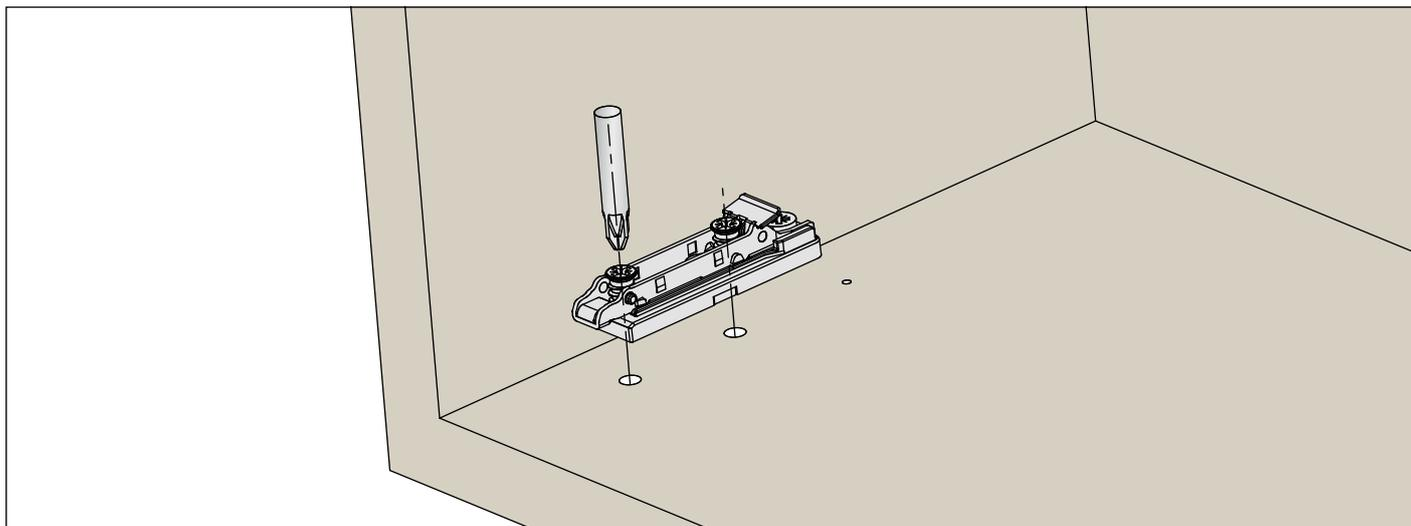
Fissare la cerniera sull'anta.
