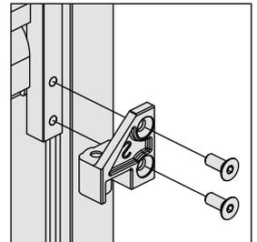
Fijar los 4 enganches sobre el lado interno de la puerta mediante los tornillos autorroscantes para madera.
