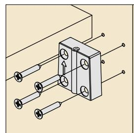
Fijar los soportes para el perfil horizontal base sobre la cara interna del panel lateral e insertar los tornillos excéntricos suministrados en el blister de accesorios.
