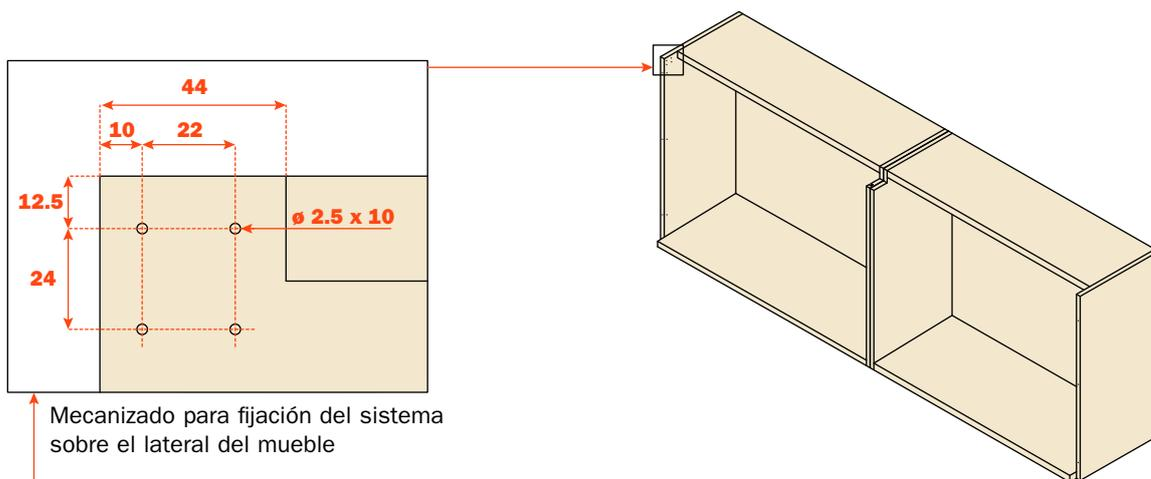
Mecanizado para fijación del sistema sobre el lateral del mueble
