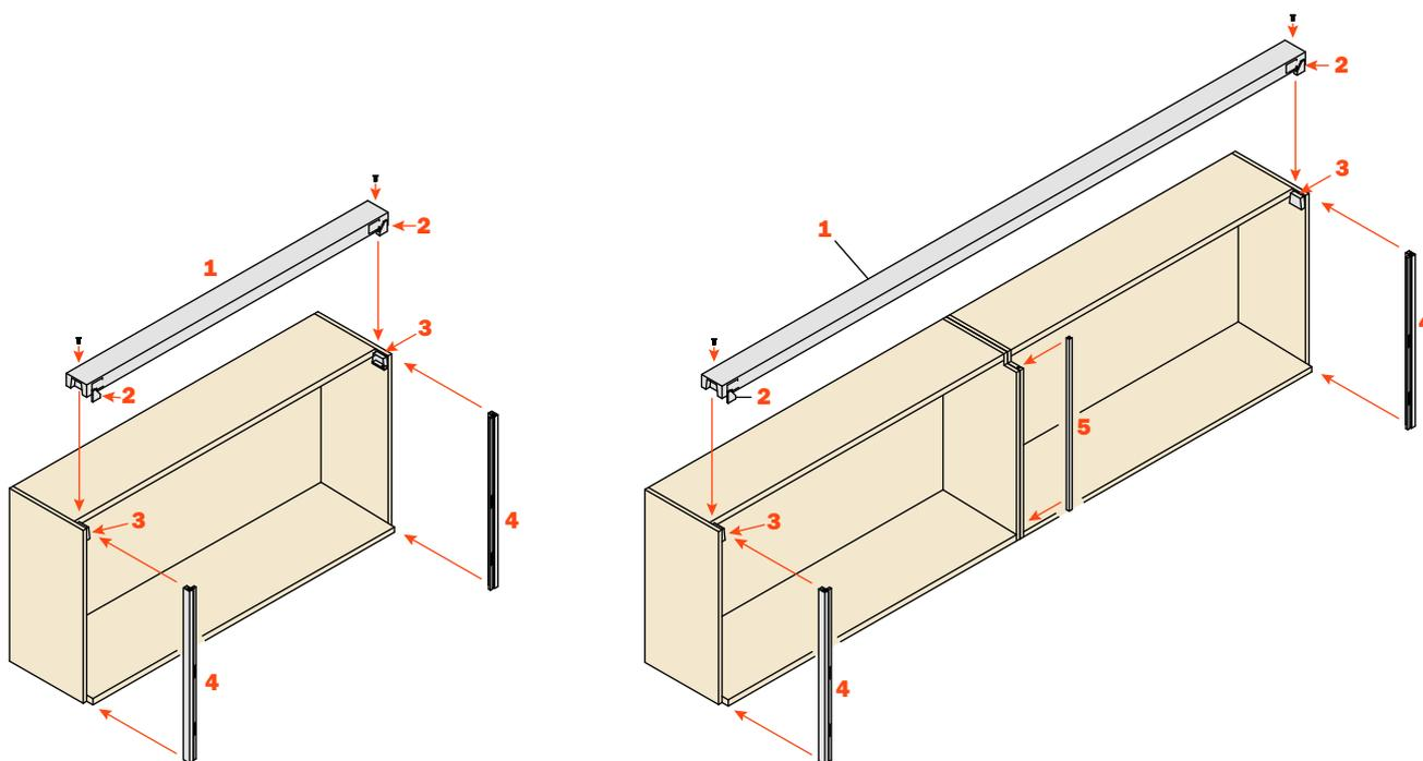
Extraer las guías correderas (3) de las guías de extracción total (4). Fijar los soportes (5) a las guías correderas mediante los tornillos suministrados en dotación. Fijar el elemento de fijación puertas (2) en la parte superior de las guías correderas (3) mediante los tornillos suministrados en dotación.
