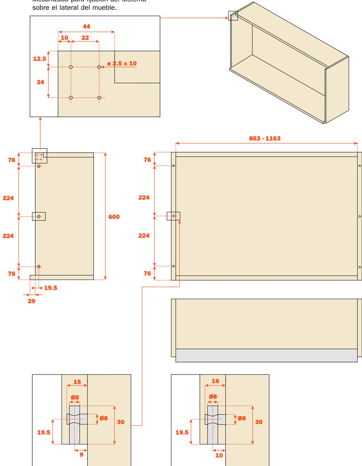
Mecanizado para fijación de la guía sobre el lateral de 18 mm
