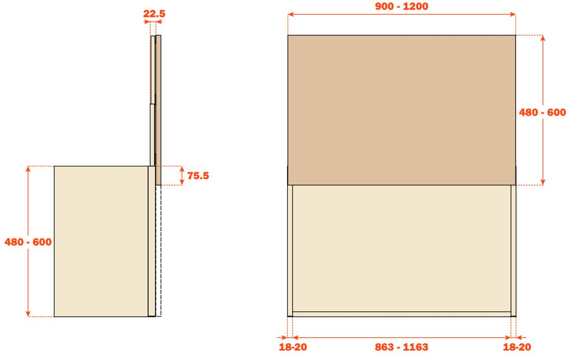
El sistema de 1800 mm y 2400 mm necesita una tercera guía y la preparación de una ranura sobre el panel central; altura 480 mm y 600 mm.
