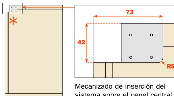
Mecanizado de inserción del sistema sobre el panel central
