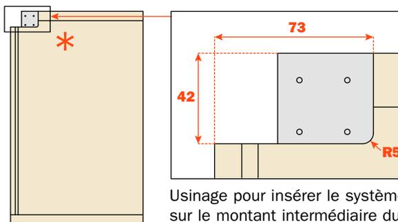
Usinage pour insérer le système sur le montant intermédiaire du meuble
