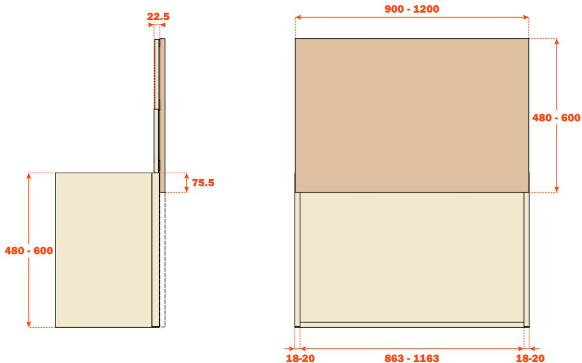
Système pour largeur 1800 mm et 2400 mm. Cette version nécessite une troisième coulisse et un usinage sur le montant central. Hauteur 480 mm et 600 mm.
