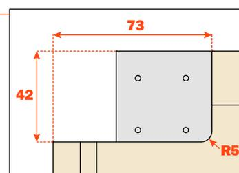
Usinage pour insérer le système sur le montant intermédiaire du meuble
