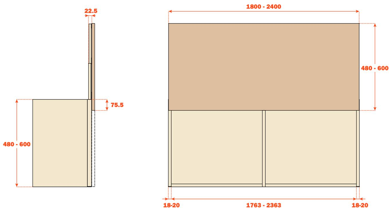
**Mover - Système pour meubles de largeur 900 mm et 1200 mm - hauteur 480 mm**
