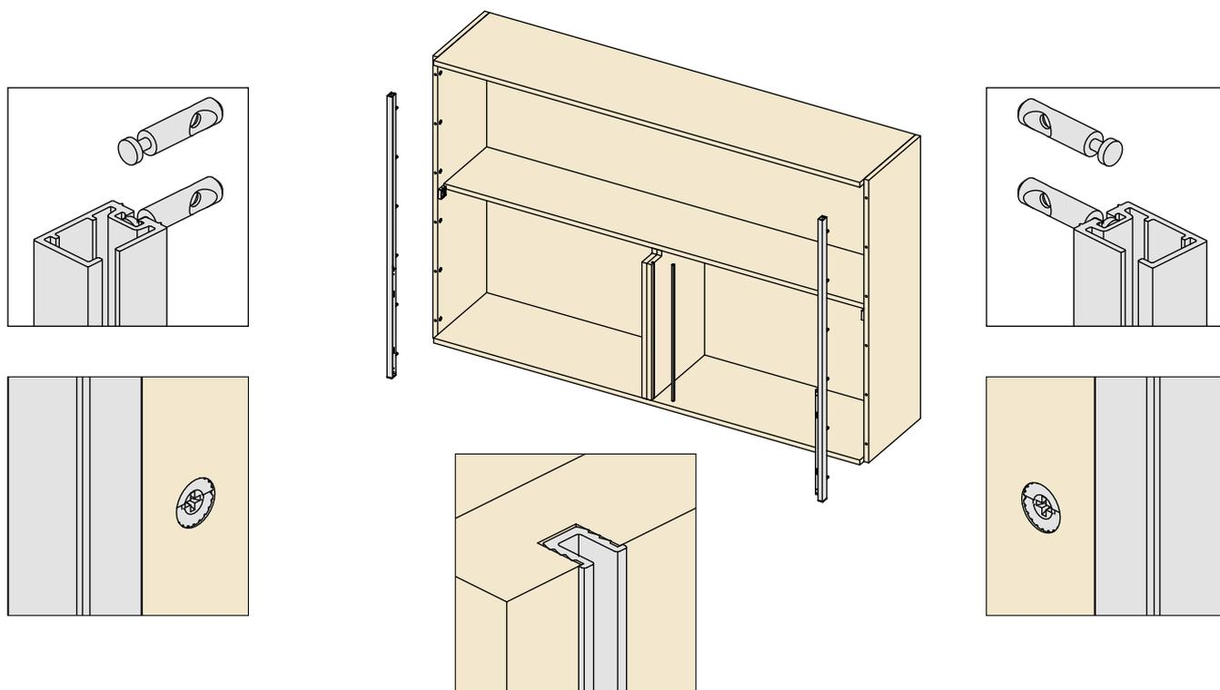
Insérer et fixer avec les vis fournies, le profilé sur les supports latéraux préalablement installés sur les côtés du meuble.
