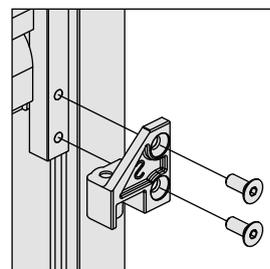
Fixer les 4 crochets sur le côté intérieur de la porte avec des vis à bois auto-tourillonnantes.
