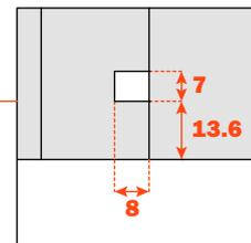
Usinage pour la fixation de la coulisse sur le côté du meuble
