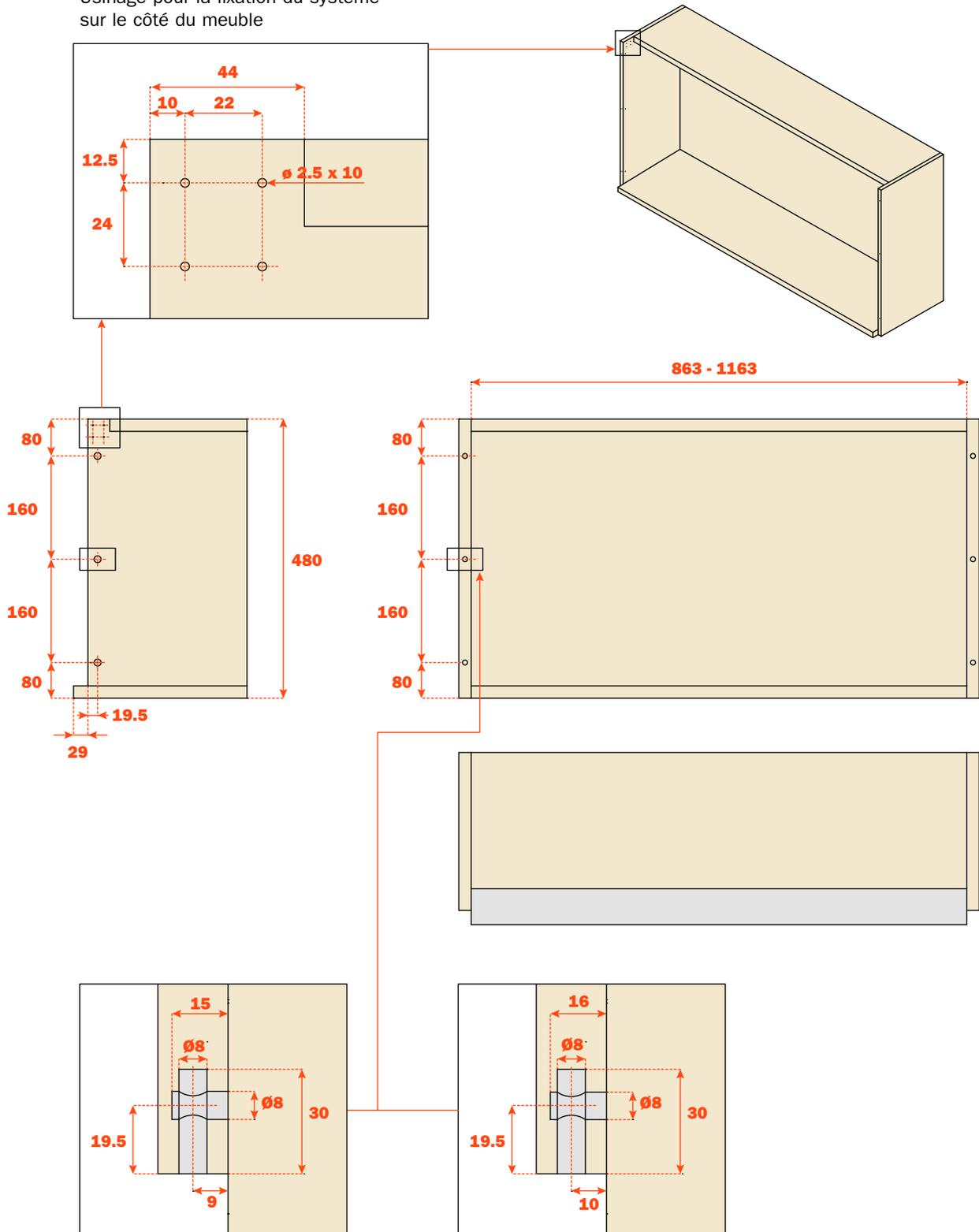
Usinage pour la fixation de la coulisse sur le côté de 18 mm
