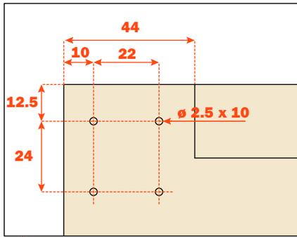
Usinage pour la fixation du système sur le côté du meuble
