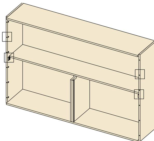
Insérer les goujons dans les coulisses et les fixer aux côtés avec les vis excentriques précédemment insérées.
