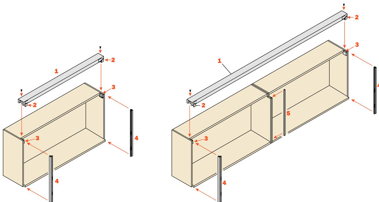
Extraire les profilés coulissants (3) des coulisses à sortie totale (4). Fixer sur ces profilés avec les vis fournies, les pièces de raccordement (5).
