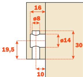
Usinage pour la fixation de la coulisse sur le côté de 19/20 mm
