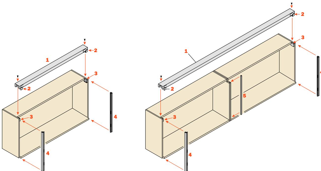
Aus den teleskopischen Schiebeschienen (4) die Gleitschienen (3) herausfahren und an diesen die Verbindungselemente (5) mit den gelieferten Schrauben befestigen.
