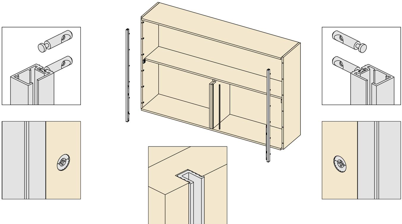
Das Profil von oben in die schon an den Außenseiten befestigten Halterungen einfügen und mit den gelieferten Schrauben befestigen.
