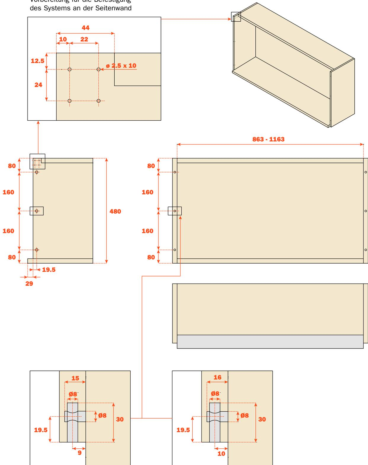
Vorbereitung für die Befestigung der Schiene an der Seitenwand - 18 mm
