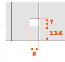
Vorbereitung für die Befestigung der Schiene an der Seitenwand des Möbels
