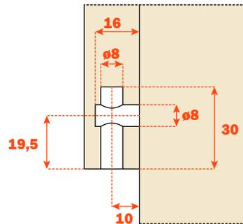
Vorbereitung für die Befestigung der Schiene an der Seitenwand - 19/20 mm
