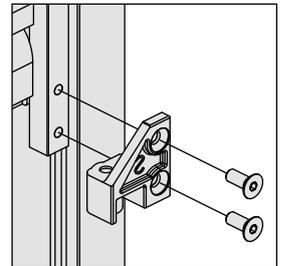
Die 4 Haken an der inneren Seite der Türen mit Selbstwindenden Schrauben befestigen.
