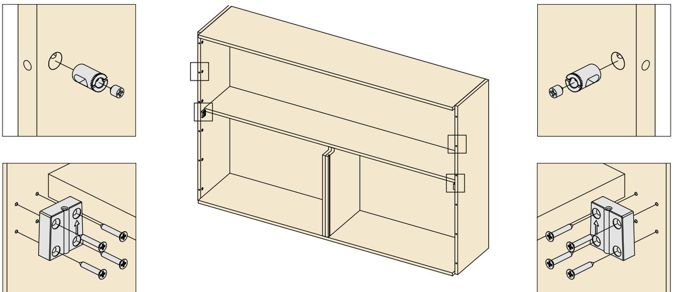
Die Verbindungsbolzen in die Führungen einführen und sie an den Außenseiten mit den zuvor eingesetzten Exzenter befestigen.
