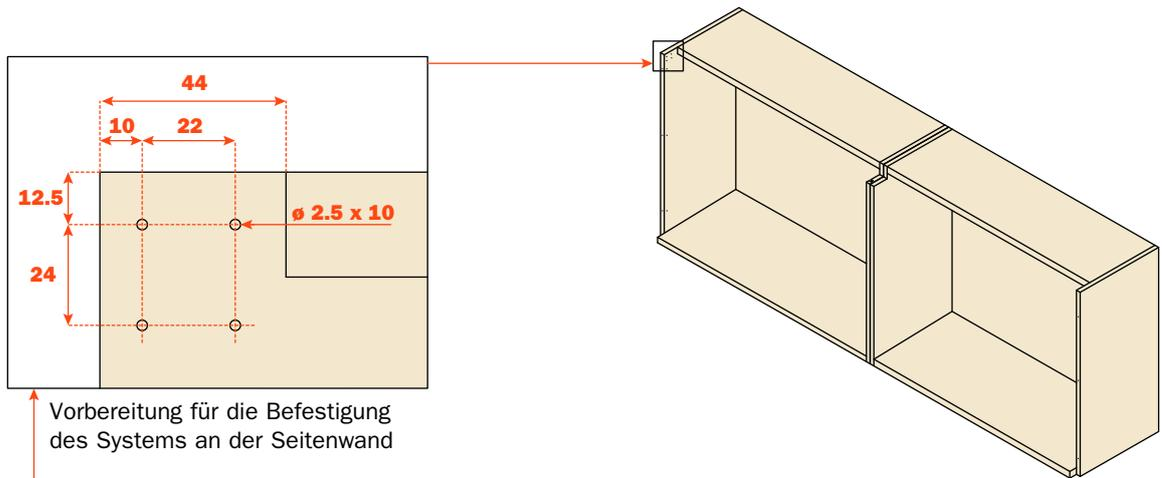
Vorbereitung für die Befestigung des Systems an der Seitenwand
