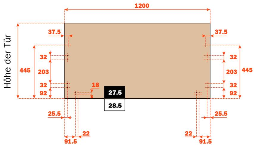
**Bohrbildabmessungen mit Seiten 18 mm**
