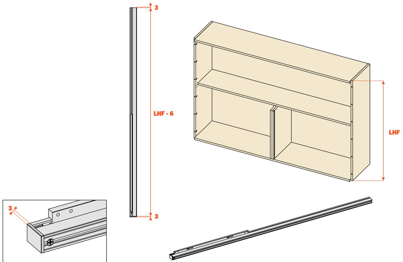
Die Halterungen für das Profil an den Außenseiten und die gelieferten Exzenter befestigen.
