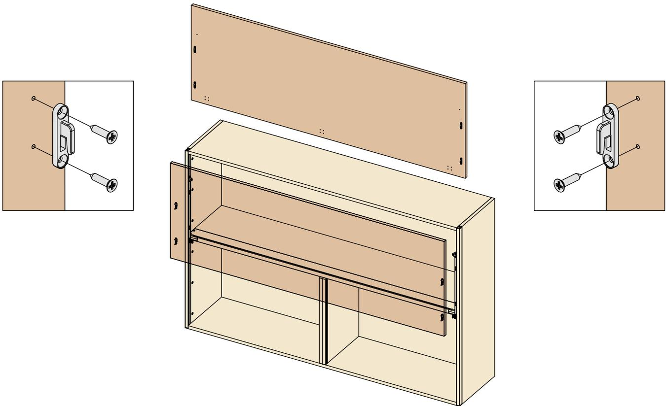
Die Türen jetzt sorgfältig nach unten gleiten lassen, bis die Befestigung der Türe mit den gelieferten Schraube am Befestigungselement möglich wird.
