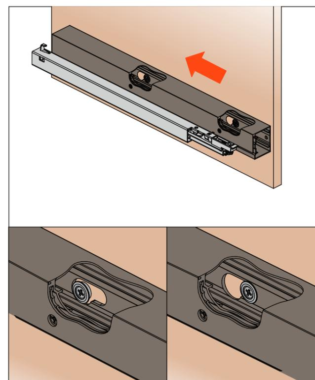
6. Fixar o distanciador com o parafuso de fixação dianteiro
