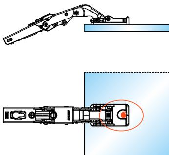
**3)** Den Topf auf die Platte positionieren und dann den Exzenter drehen.
