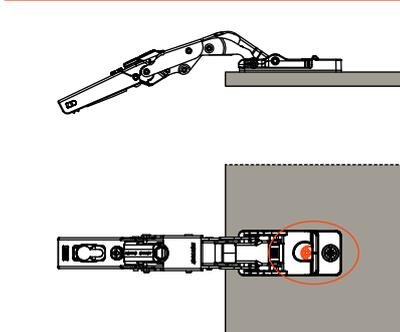
**3)** Den Topf auf die Platte positionieren und dann den Exzenter drehen.
