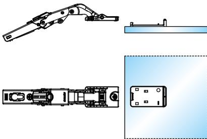
**1)** Die Platte mit einem speziellen Kleber auf der Glas- oder Spiegeltür befestigen. Es wird empfohlen, das Aufkleben von Firmen, die auf Glasverarbeitung spezialisiert sind, durchführen zu lassen. Für weitere Informationen über den Kleber und seine Anwendung können Sie sich an den Klebehersteller oder Ihren Glastür-Lieferanten wenden.
