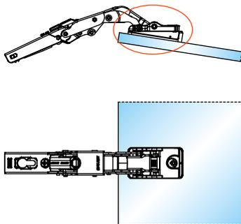
**2)** Das Scharnier montieren, wenn die Platte gut befestigt ist.
