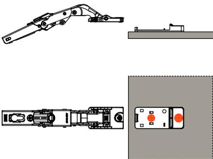
**1)** Die Platte mit den gelieferten Schrauben an die Tür anschrauben.
