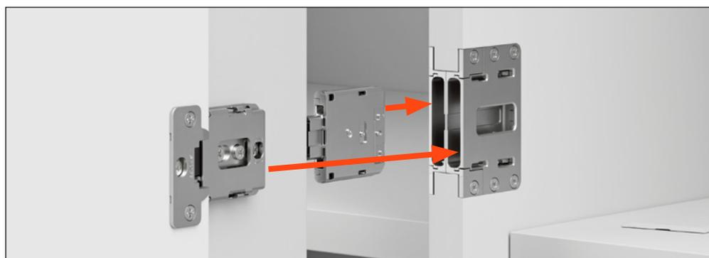
Una vez completamente insertadas, bloquear las bisagras a través de la excéntrica posterior.
