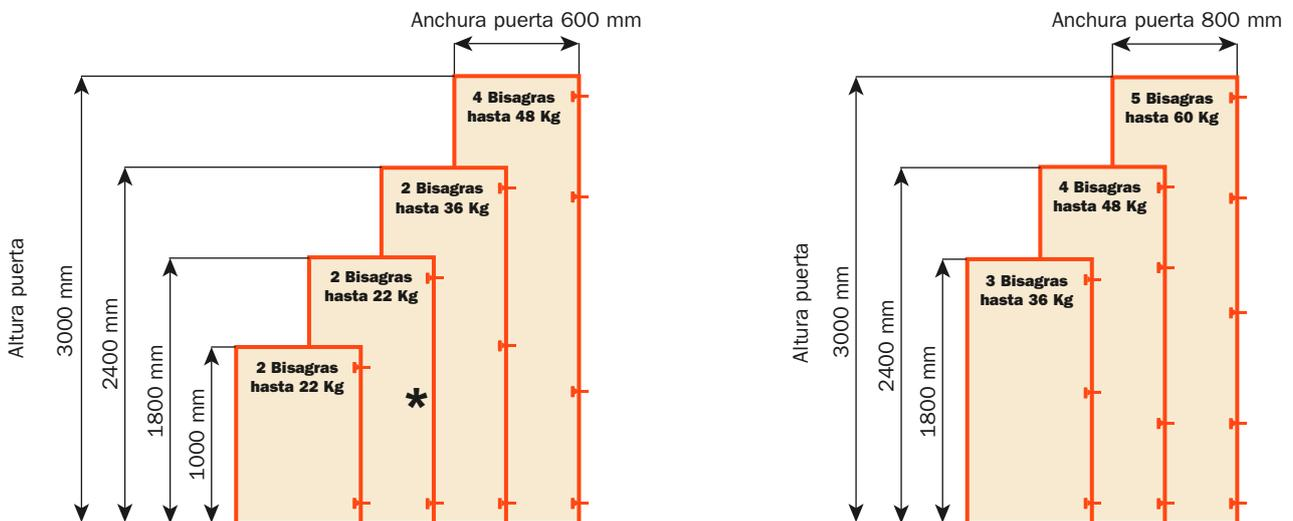
\* La colocación de una bisagra extra mejora la rigidez de la puerta y permite pesos superiores a los indicados.
