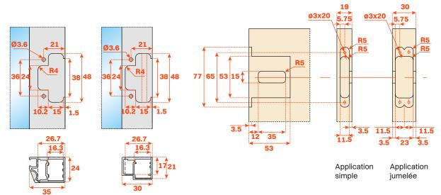
Charnière avec fermeture amortie pour portes en bois et avec profilé en aluminium 180°
