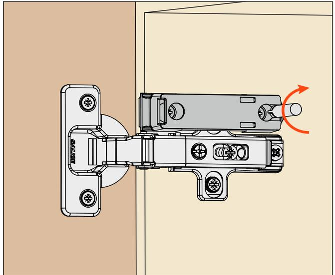
Den Smovehalter einsetzen und ihn bis zum Einrasten in Pfeilrichtung schieben.
