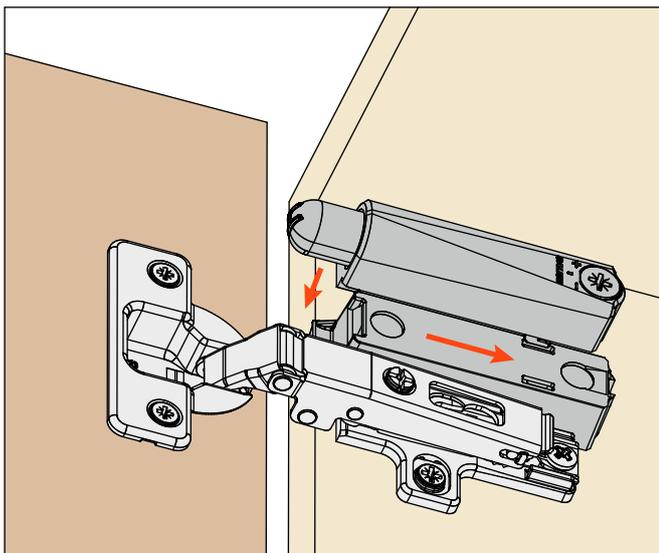
Durch die hintere Verstellerschraube lässt sich der Dämpfungseffekt erhöhen oder reduzieren.
