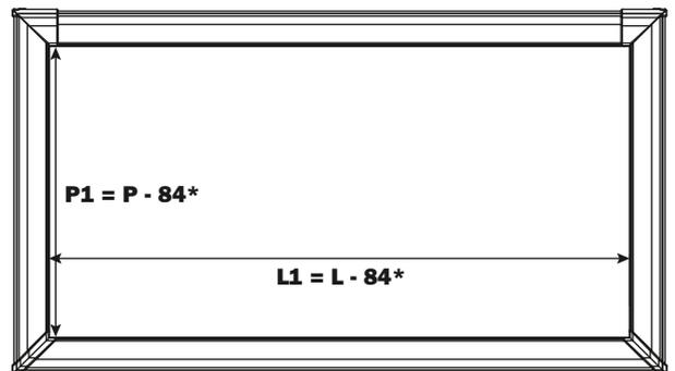
\* dimensions intérieures des ferrures d'assemblage
