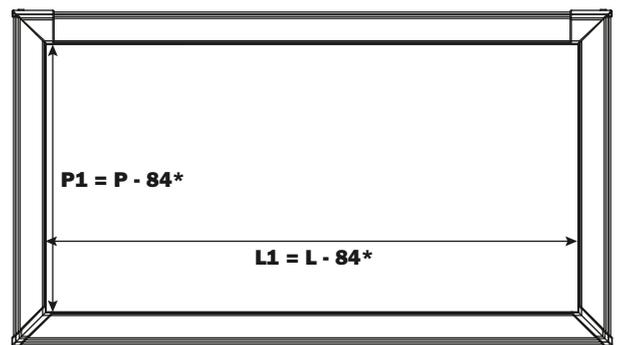
\* dimensions intérieures des ferrures d'assemblage
