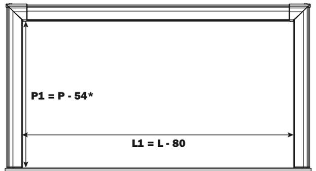
\* dimensions intérieures des ferrures d'assemblage
