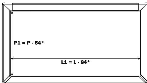
\* dimensions intérieures des ferrures d'assemblage
