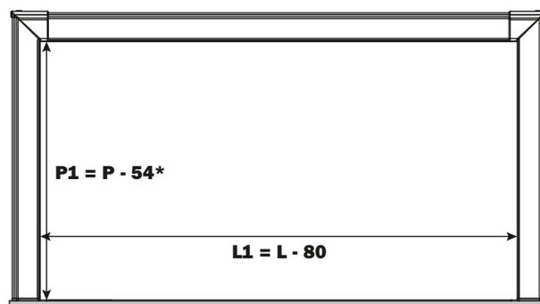
\* dimensions intérieures des ferrures d'assemblage
