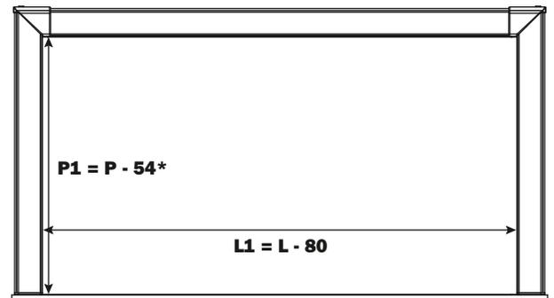
\* dimensions intérieures des ferrures d'assemblage
