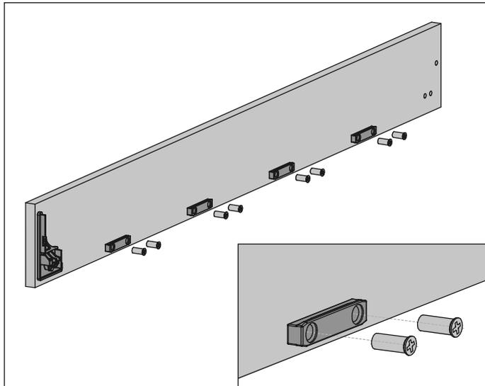
3. Inserire e far scorrere il profilo anteriore sulle slitte di ancoraggio. Profilo supporto frontale da tagliare a misura a misura a 90°, vedere pagine 7, 9, 11.
