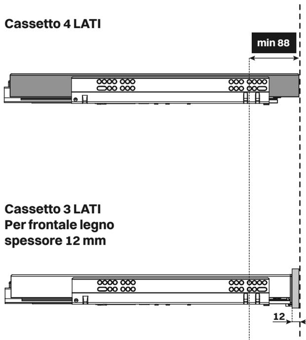
I cassette 4 lati **non sono, a parità di foratura, allineati frontalmente** con i cassette 3 lati frontale legno (spessore 19 mm) come da schema illustrativo qui sotto riportato.
