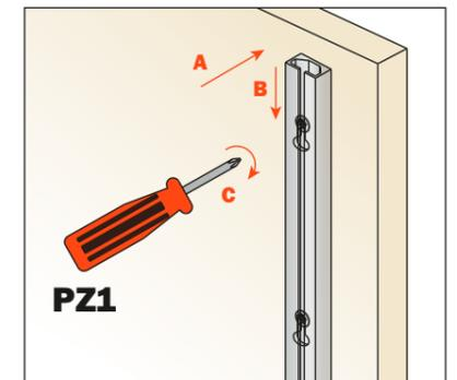
Fijación a pared para la aplicación del perfil a la vista.
