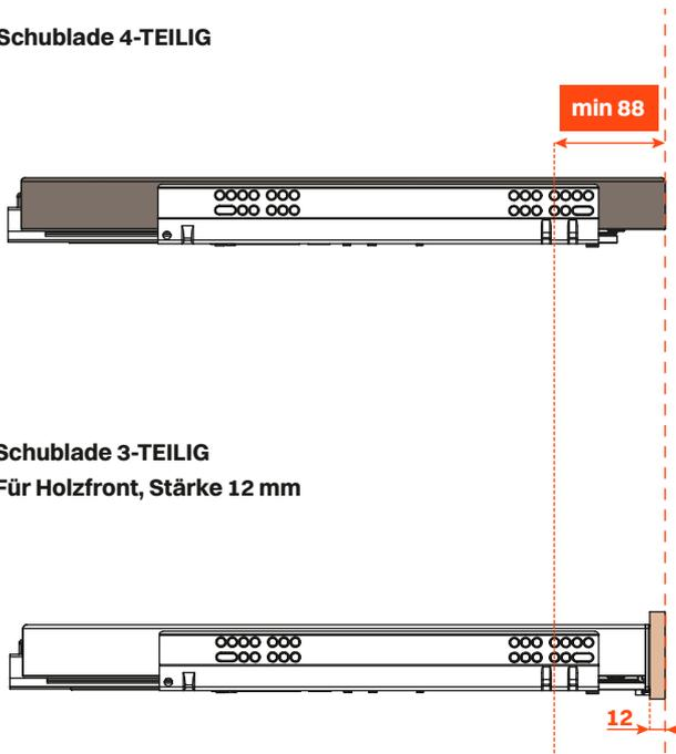
Die Schubladen 4-teilig **sind, bei gleicher Bohrung,** mit den Schubladen 3-teilig und Holzfront (19 mm Stärke) **nicht frontal bündig**, wie unten dargestellt.
