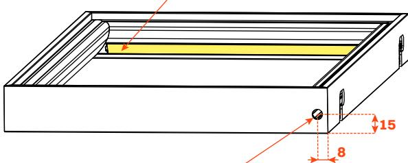
Perçage de sortie du câble électrique
