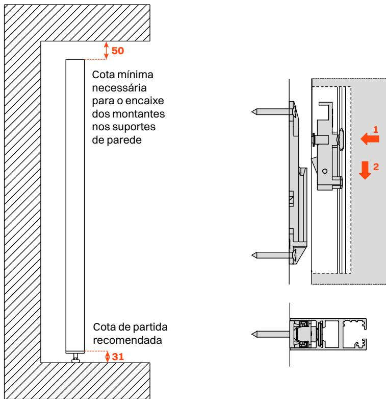
**Fixação do primeiro montante à parede e posicionamento dos suportes**
