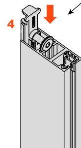
Bloquer l'élément de fixation dans le profil en respectant les cotes indiquées par le configateur
