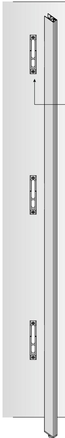
Lösen Sie die Schraube und ziehen Sie das Wandbefestigungselement heraus
