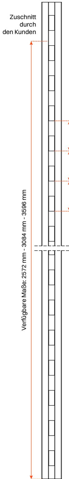
Vor dem Zuschneiden überprüfen Sie bitte, ob die Position der Aussparung für den Einbau des elektrischen Schalters (optional) wie in der Zeichnung angegeben auf der rechten Seite liegt
