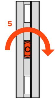
Das Befestigungselement im Profil unter Beachtung der im Konfigurator angegebenen Maße arretieren
