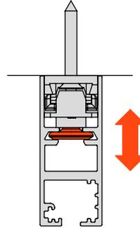
Regolazione laterale montante singolo  $\pm 2.5$  mm
