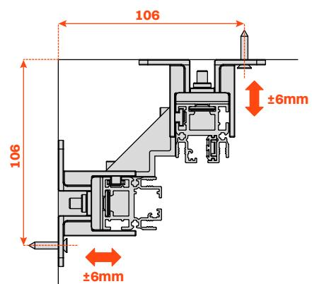
Le réglage frontal d'un profilé vertical entraîne le déplacement latéral de l'autre profilé
