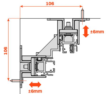
Die frontale Verstellung eines Ständerprofils bewirkt die seitliche Verschiebung des anderen.
