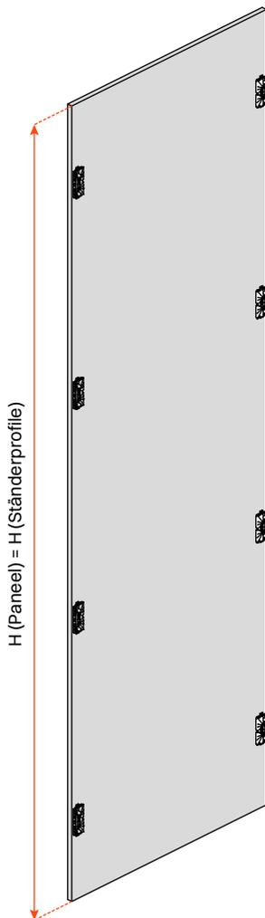
Selbstzentrierende Clips zur Befestigung der Paneele
