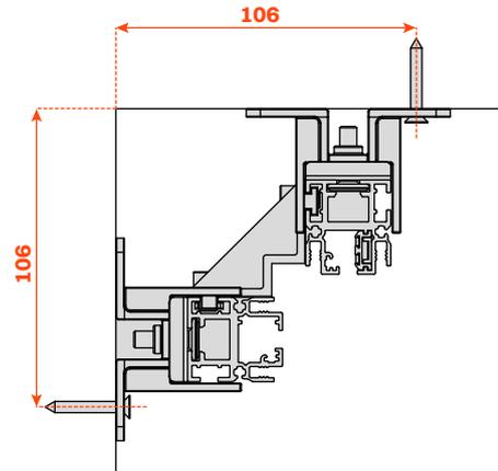
Vor dem Zuschneiden überprüfen Sie bitte, ob die Position der Aussparung für den Einbau der elektrifizierten Schiene (optional) rechts liegt, wie in der Zeichnung angegeben.
