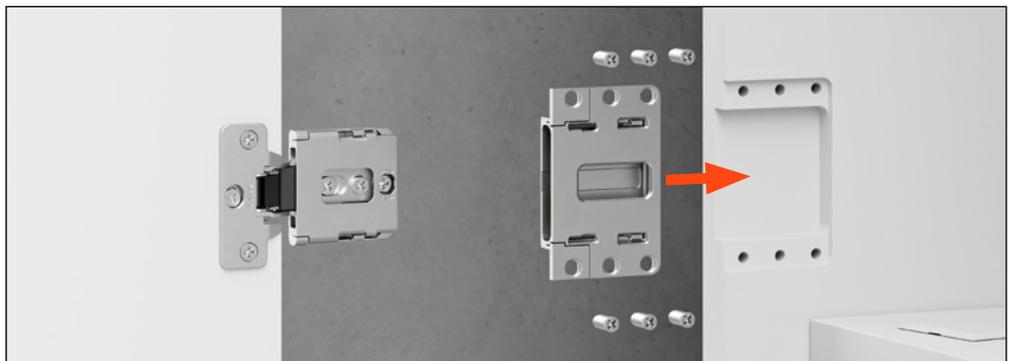
Das Scharnier vollständig in die Aufnahmetaschen einsetzen
