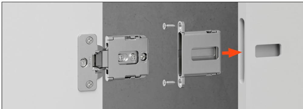
Das Scharnier vollständig in die Aufnahmetaschen einsetzen
