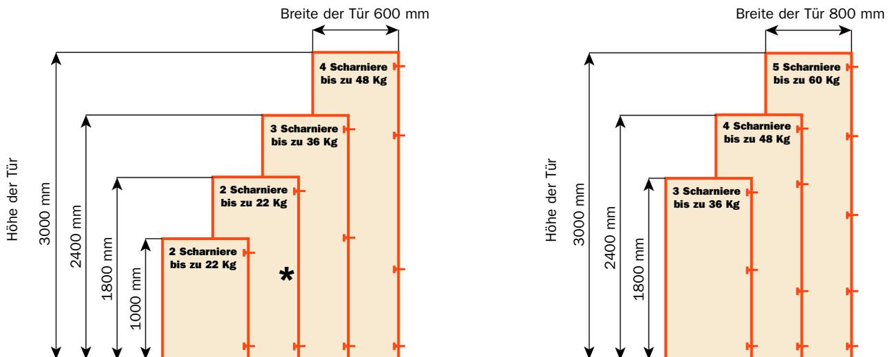
\* Das Hinzufügen eines Scharniers verbessert die Steifigkeit der Tür und ermöglicht höhere Gewichte als angegeben.
