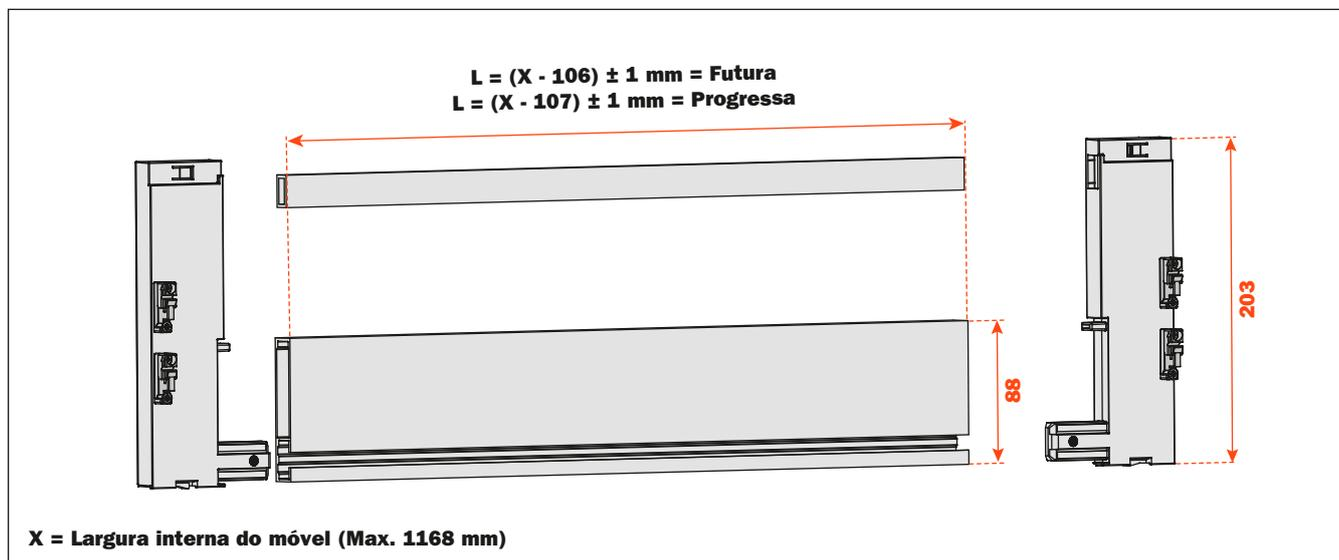
Inserir os terminais no perfil frontal e na barra e parafusar.
