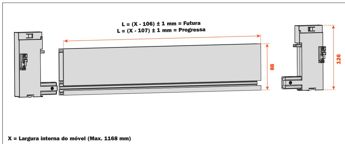
Inserir os terminais no perfil frontal e parafusar.
