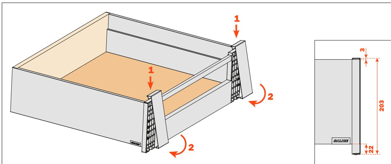
Para corrigir quaisquer erros de corte do perfil, solte e reaperte os parafusos indicados
