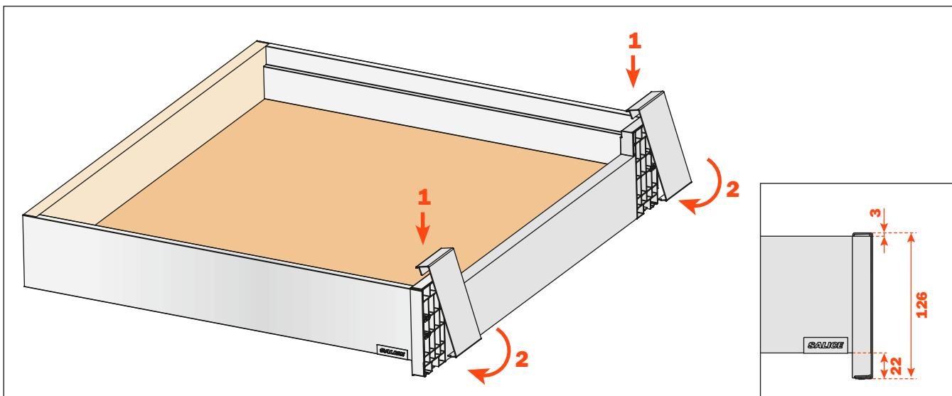
Para corregir cualquier error de corte del perfil, aflojar y apretar los tornillos indicados.
