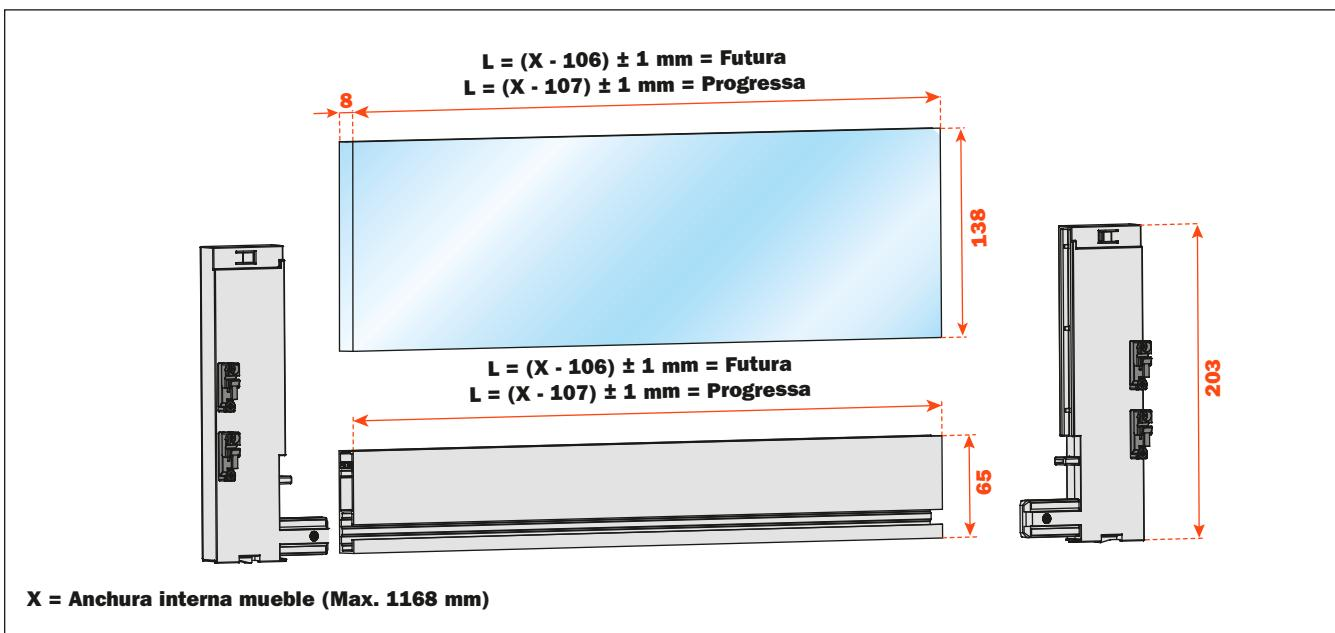
Insertar los terminales en el perfil frontal y en la barra y atomillar.
