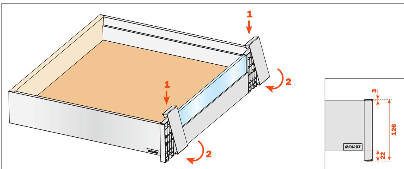
Um eventuelle Profilschnittfehler zu beheben, lösen Sie die angegebenen Schrauben und ziehen Sie sie wieder an
