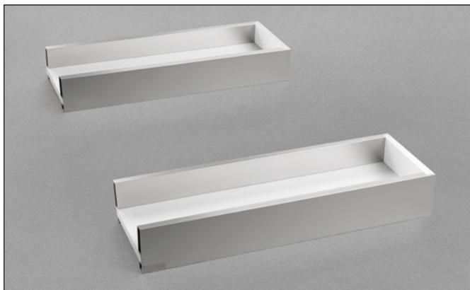
**Laterais metálicas Lineabox Easy, fundo e traseira em madeira. Altura da lateral 75 mm - Altura interna 46 mm. Para todas as corredeiras Progressa e Futura extração total.**
