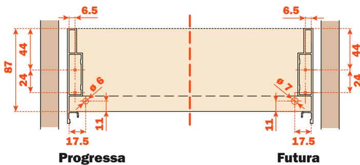
**Lineabox Easy - 2-teilig - Verdeckte Rückwand - H 178 mm**
