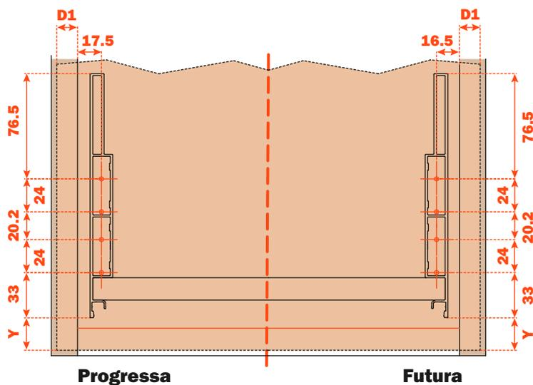
**D1 = Recouvrement de la façade sur le côté du meuble**
