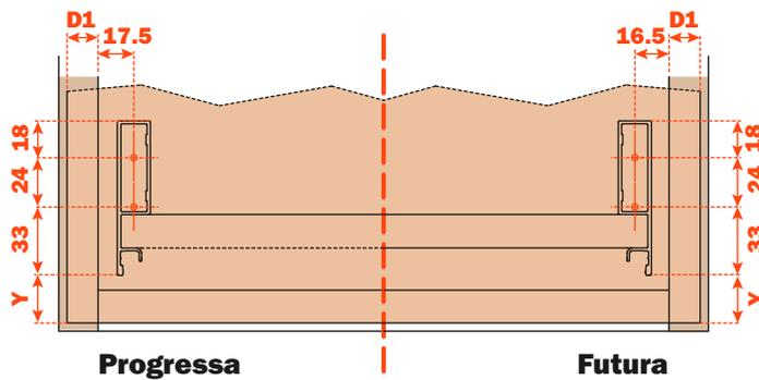
**D1 = Recouvrement de la façade sur le côté du meuble**
