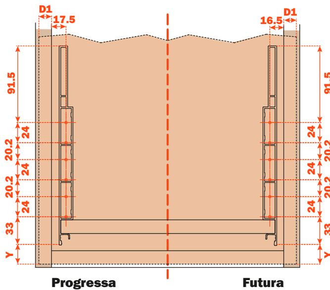
**D1 = Recouvrement de la façade sur le côté du meuble**
