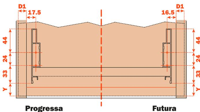
**D1 = Recouvrement de la façade sur le côté du meuble**
