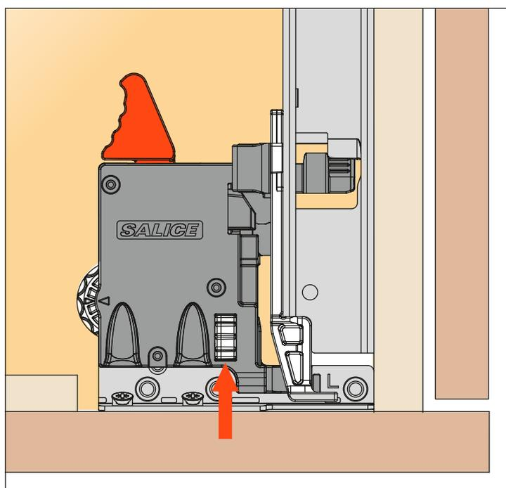
Se recomienda llevar a cabo la regulación lateral en ambos clips en la misma dirección para asegurar que las guías permanezcan paralelas y se deslicen correctamente.
