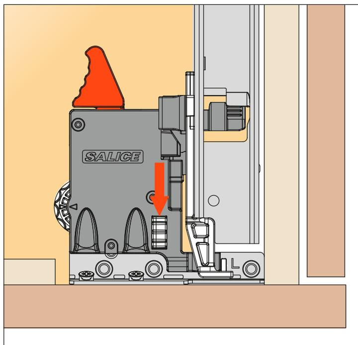
Girar la rueda blanca hacia la parte posterior del cajón para ajustar hacia la derecha.
