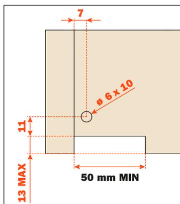
**SCARICO POSTERIORE con sincronizzatore per guide Push e con leva per la regolazione dell'inclinazione**
