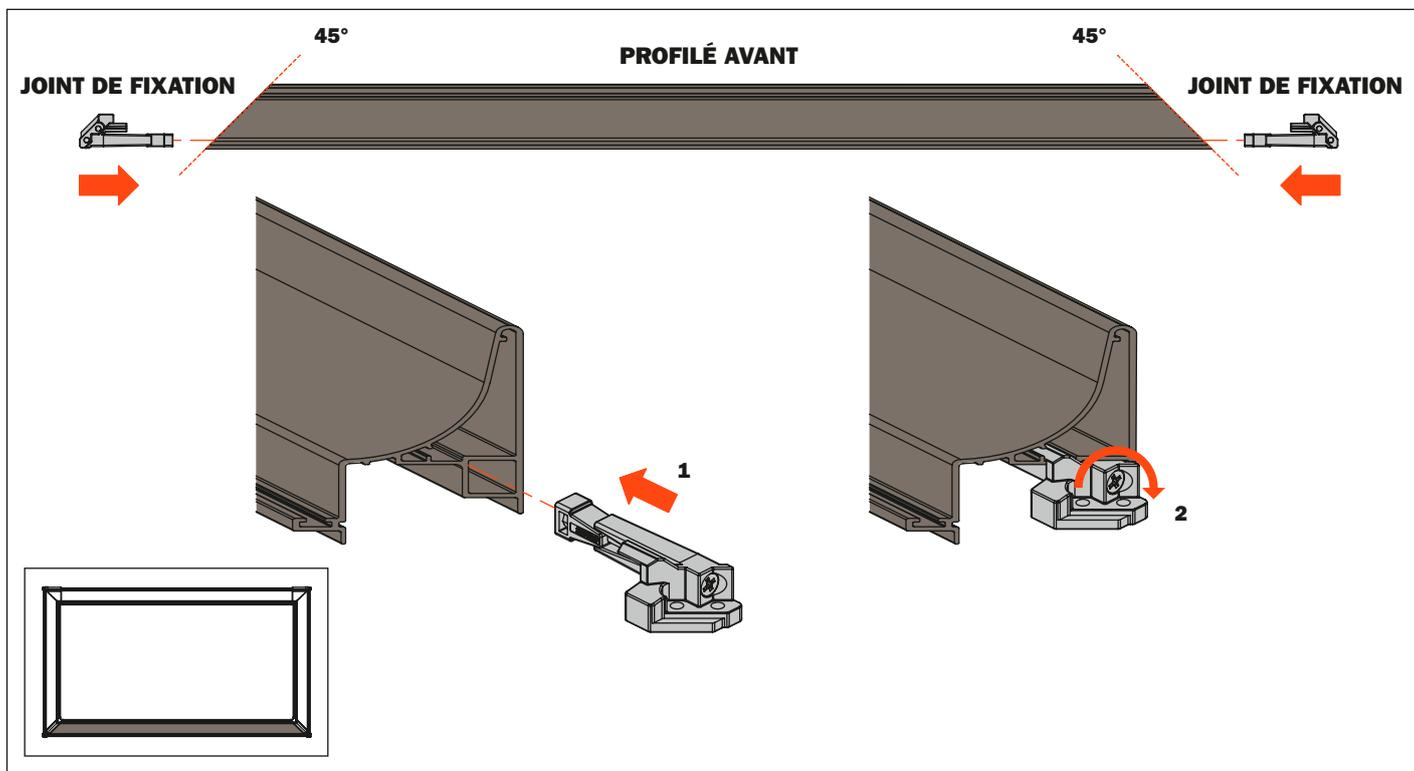
3. Insérer les ferrures d'assemblage avant sur le profilé avant jusqu'à ce qu'ils atteignent la butée
