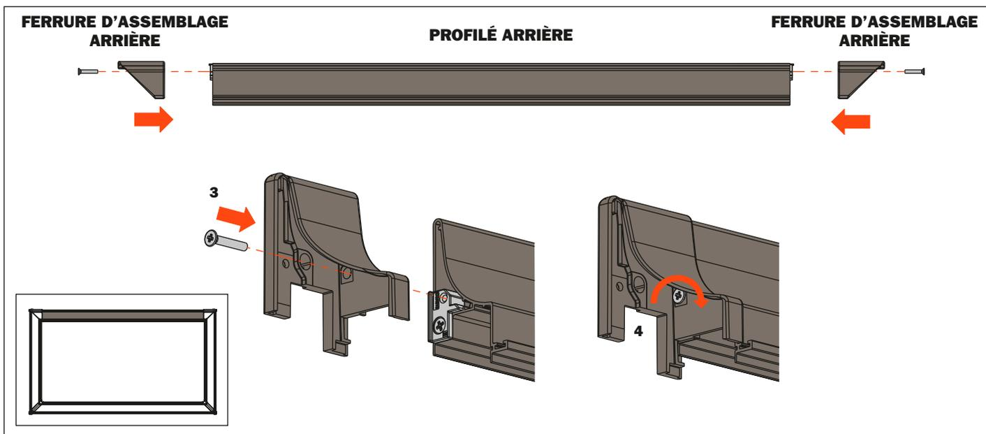
5. Insérer les profilés latéraux dans les ferrures d'assemblage
