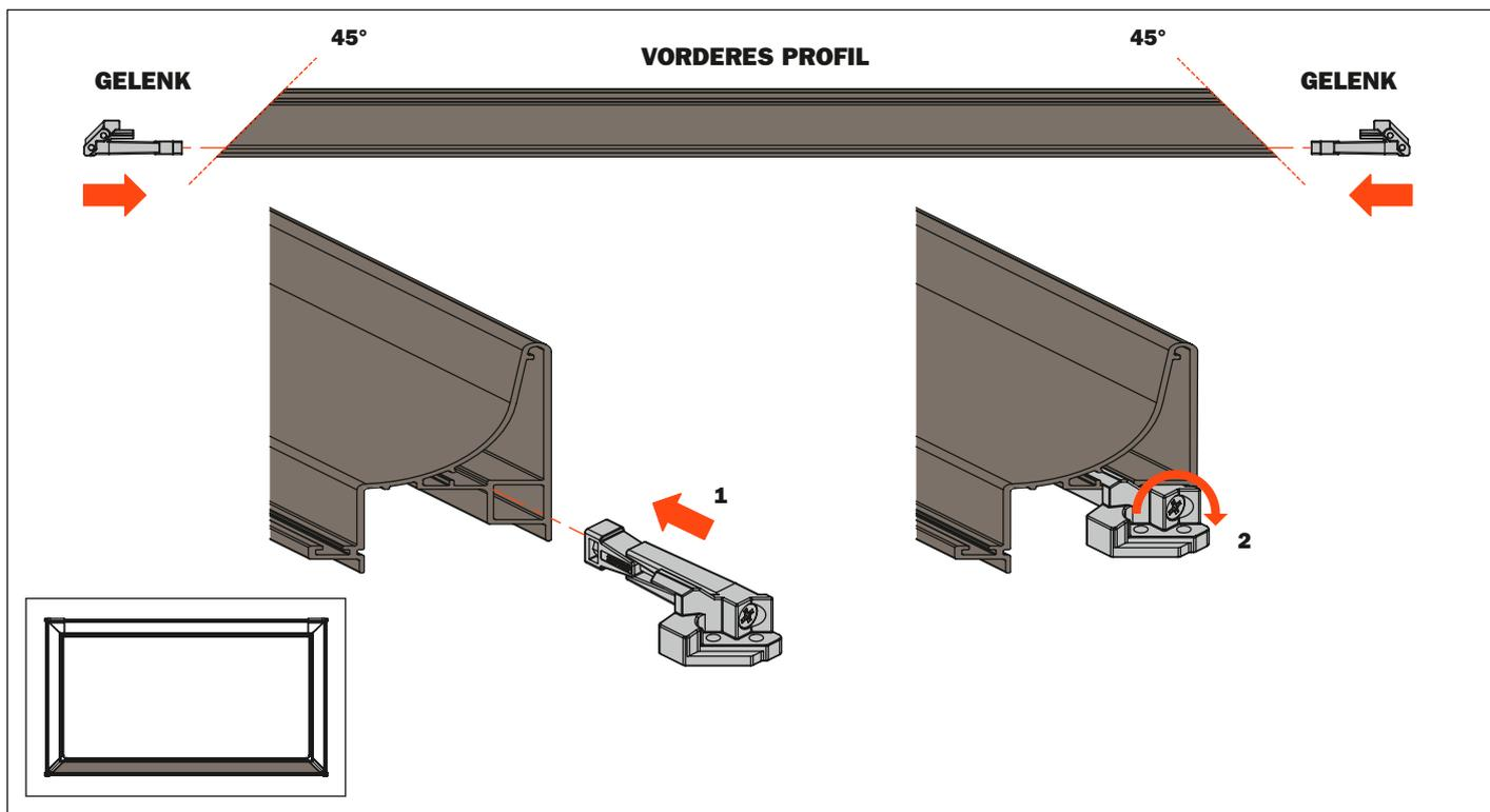
3. Die vorderen Eckverbinder auf das vordere Profil bis zum Anschlag einsetzen
