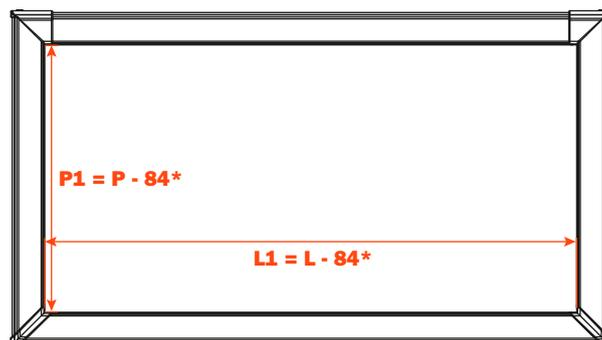
\* dimensions intérieures des ferrures d'assemblage
