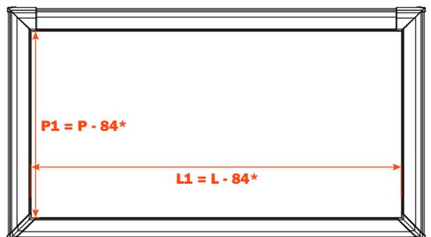
\* dimensions intérieures des ferrures d'assemblage
