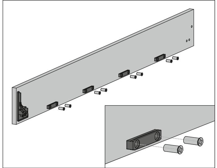
3. Das vordere Profil in die Verbindungselemente einsetzen und aufschieben
