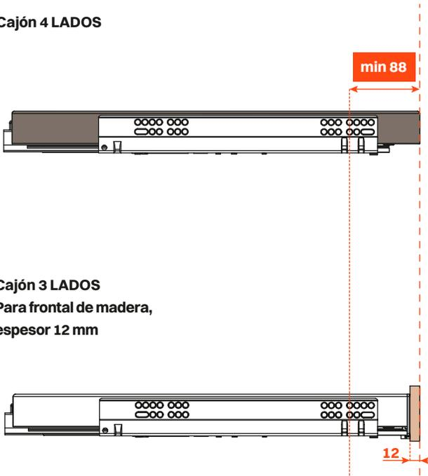
Los cajones de 4 lados, **las mismas perforaciones no están alineados frontalmente**, con los cajones de 3 lados frontal de madera (espesor 19 mm) como se indica en el esquema a continuación.
