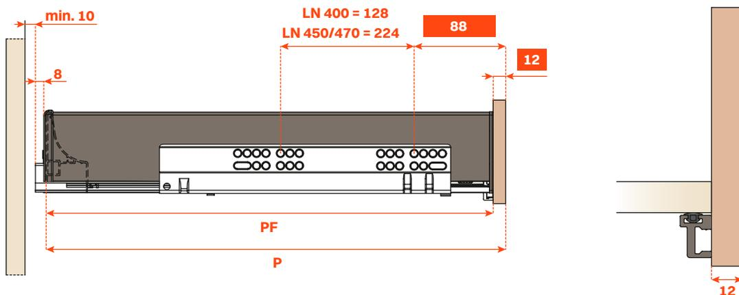
Cajón 3 LADOS - Para frontal de madera espesor 19 mm
