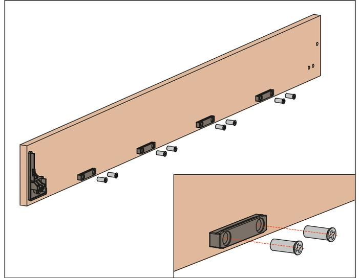
3. Insertar y deslizar el perfil anterior sobre los patines de fijación
