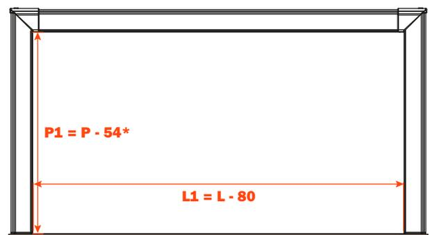
\* dimensions intérieures des ferrures d'assemblage
