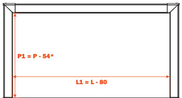
\* dimensions intérieures des ferrures d'assemblage
