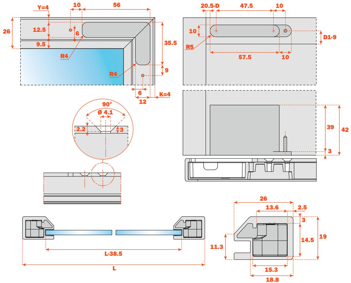
**Formules pour le calcul des côtes de perçage pour l'application des inserts pour les bras.**
