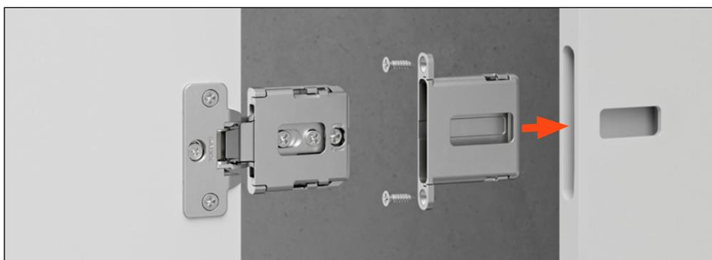
Insertar completamente la bisagra en el contenedor
