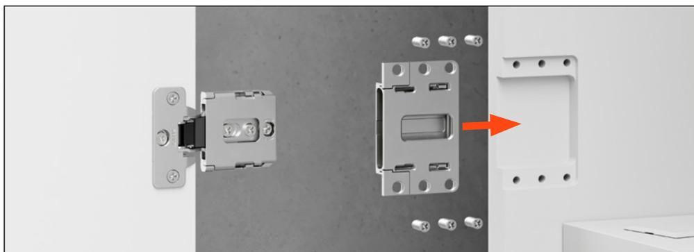
Inserire completamente la cerniera nel contenitore
